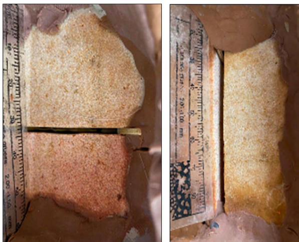
Figura 4. Fractura tipo planar diseñada en laboratorio para la muestra de la Formación Los Santos.
