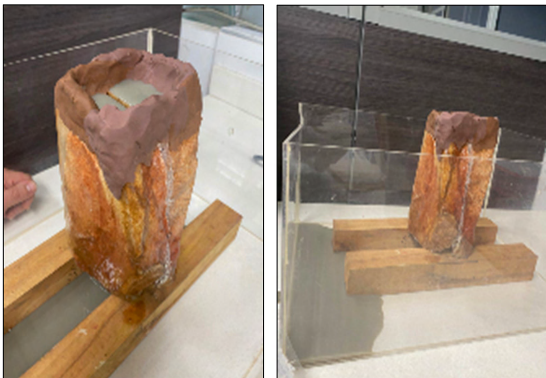
Figura 5. Entrada y salida de lodo a través de la fractura planar presente en la muestra.
