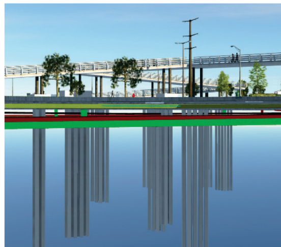
Figura 8. Cimentación de un puente peatonal proyectada LOD 350
